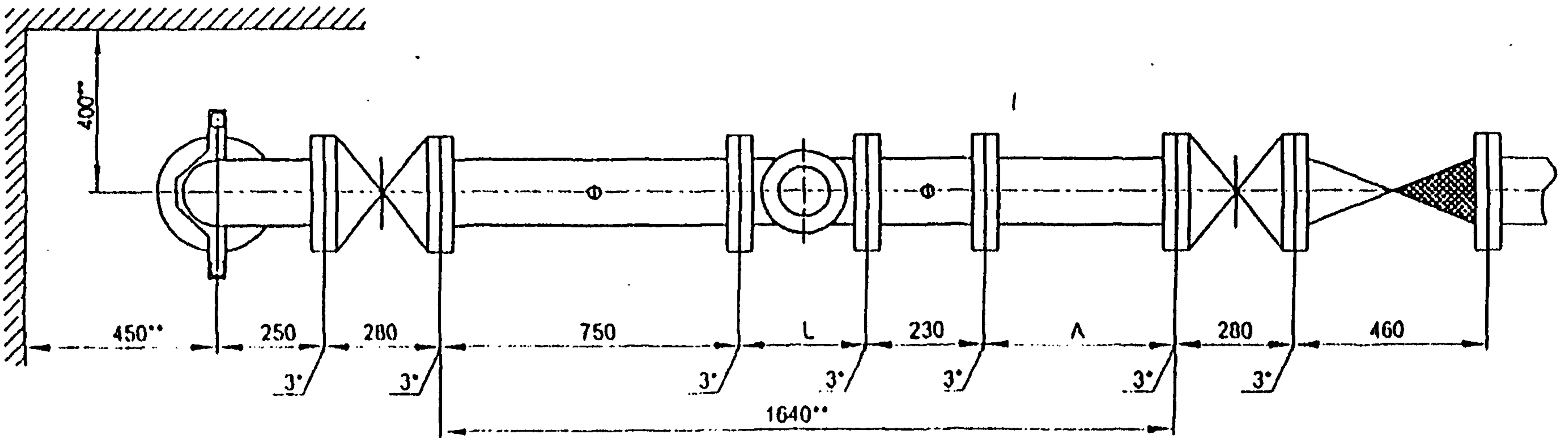
Установка счетчиков Dу=150 мм в водометном узле
